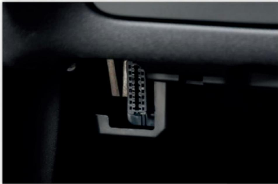
Разъем чаще всего располагается под рулевым колесом, над педалями газа и тормоза, либо в центральной консоли, бардачке, или ином месте. Зависит от марки и модели автомобиля, подробнее о нахождении разъема сказано в руководстве по эксплуатации вашего автомобиля.
